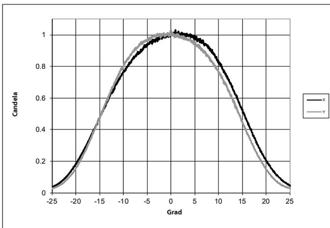
Iso-Beleuchtungsdiagramm (Fläche Oberflächenverteilung)
